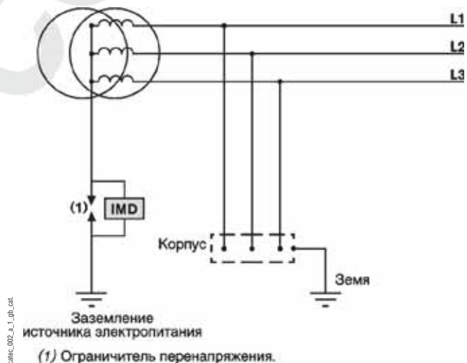
Рис. 2. Схема IT без распределения нейтрали.
